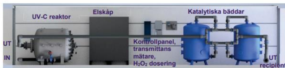
Figur 1. Schematisk översikt över Advanox™-piloten (bild från Van Remmen UV Technology).
