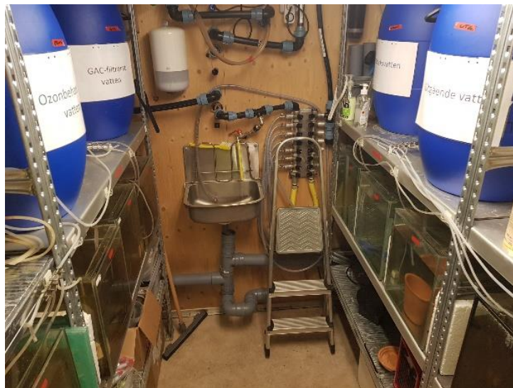
Figur 19 Försökscontainer visande fördelningstunnor och försöksakvarier för zebrafiskstudier.
