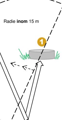
Anläggning 2 ligger inom en radie på 15 meter från anläggning 1 och utifrån slangdragningens riktning.
