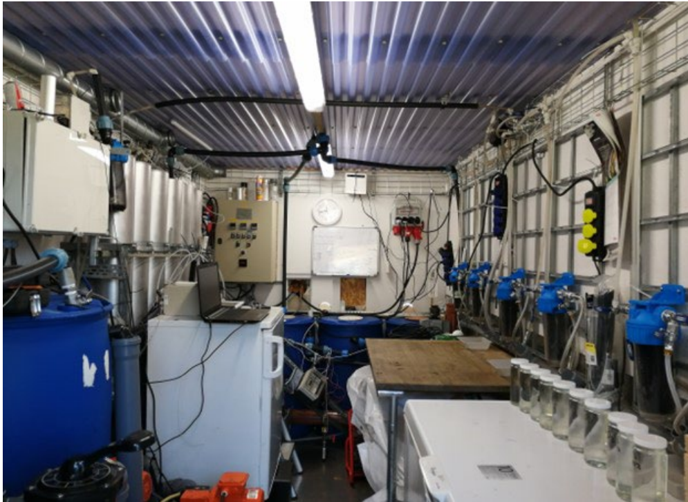
Figur 3.1.2: Interiör av pilotanläggningen. Förbehandling och pilotlinjer till vänster, labkolfilter till höger.
