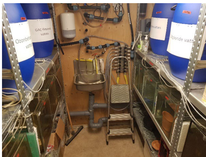
Fig. 1. Försökscontainer visande fördelningstunnor och försöksakvarier för zebrafiskstudier.
