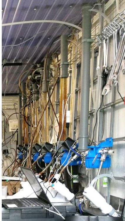
Figur 7. De fem labkolfiltren som drevs kontinuerligt och parallellt med pilotlinjerna.
