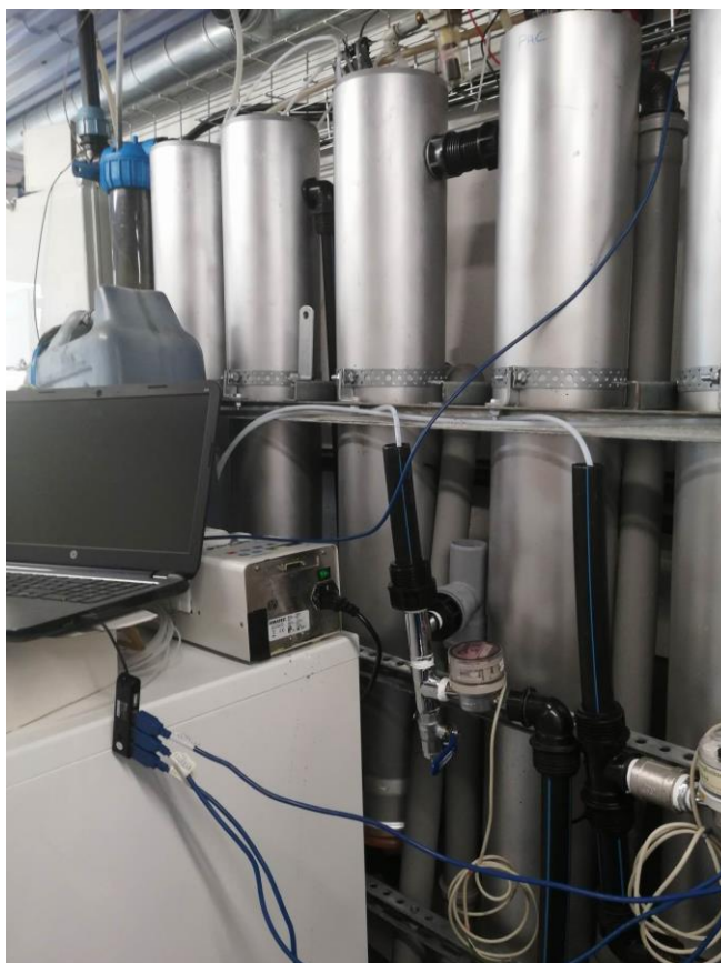
Figur 5. PAC-linjen: inblandningsbehållare, tre kontakttankar i serie och ett sandfilter.
