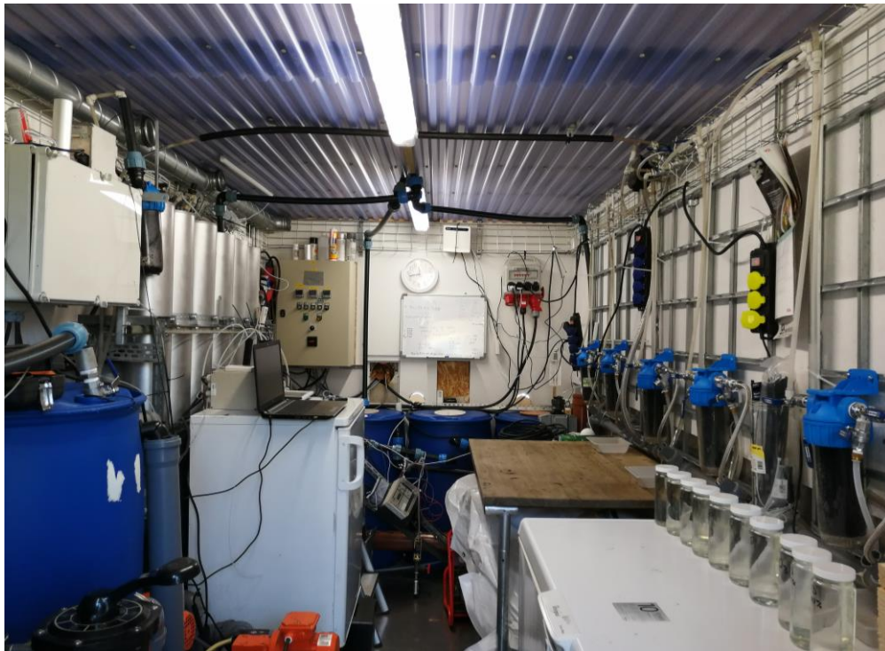
Figur 2. Interiör av pilotanläggningen. Pilotlinjer till vänster, labkolfilter till höger (bild skall uppdateras).
